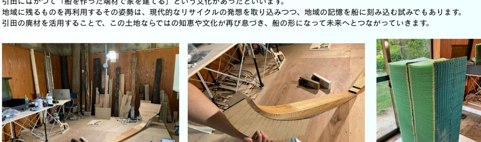
制作中の奉納和船。船底の中心となる「底板（センバ）」の部分の制作が進められていた。
